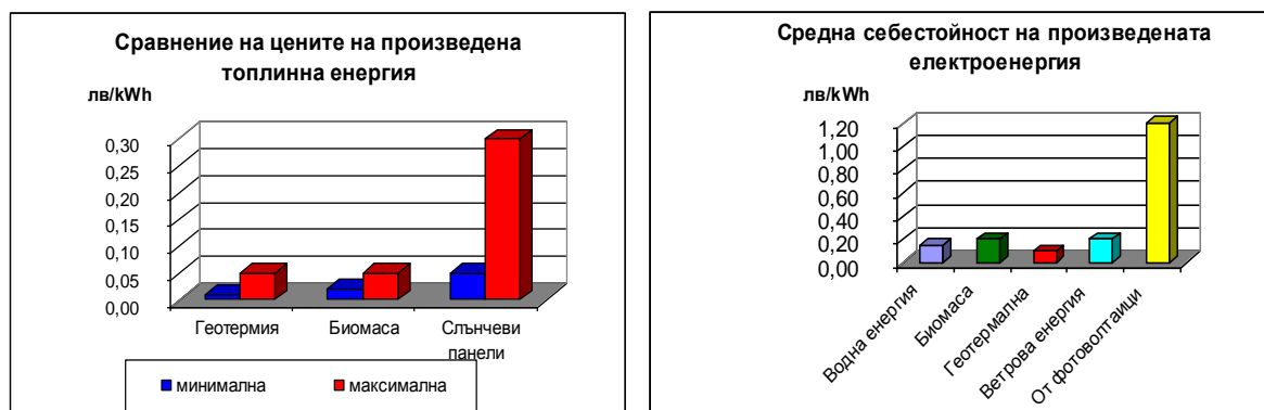
Фиг. 11: Средна себестойност на произведената от ВЕИ енергия по световна оценка в лева
